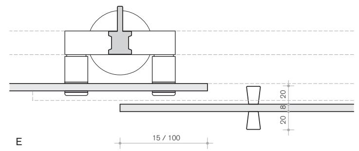
**E.** maniglia in alluminio con sezione trapezoidale applicata sul cristallo. Misura standard: H 180mm, a richiesta fino H 920mm
